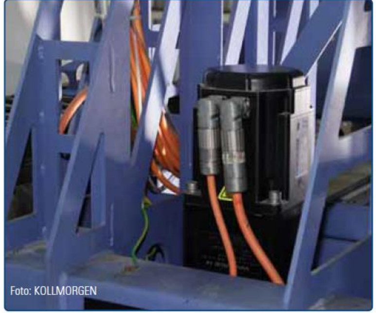
La nuova generazione di macchine da taglio per lamiere piane utilizza anche iservomotori rotativi serie AKM Kollmorgen con teste di riduzione planetarie serieMicron™.
